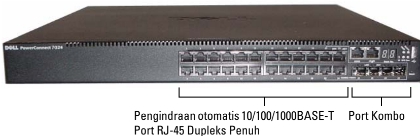
Gambar 1-2. PowerConnect 7024P dengan 24 Port PoE Plus 10/100/1000BASE-T
